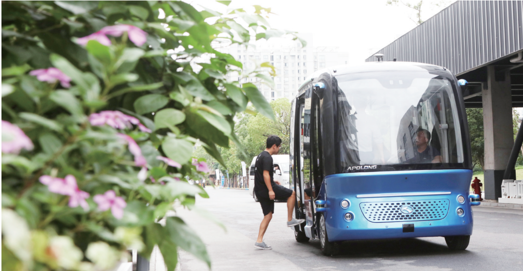
“阿波龙”由百度的Apollo开源平台提供动力支持,该平台具有L4级自动驾驶能力,车身顶部和两侧后方配置3个激光雷达,搭载人脸识别、语音识别等,时速在40公里每小时左右,充一次电可行驶100公里。 ■记者 朱良城 摄
