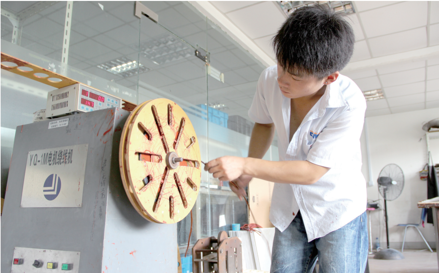
图为8月23日,上海天剑电磁技术有限公司的技术工人正为商用电磁灶制作电磁加热线盘。
