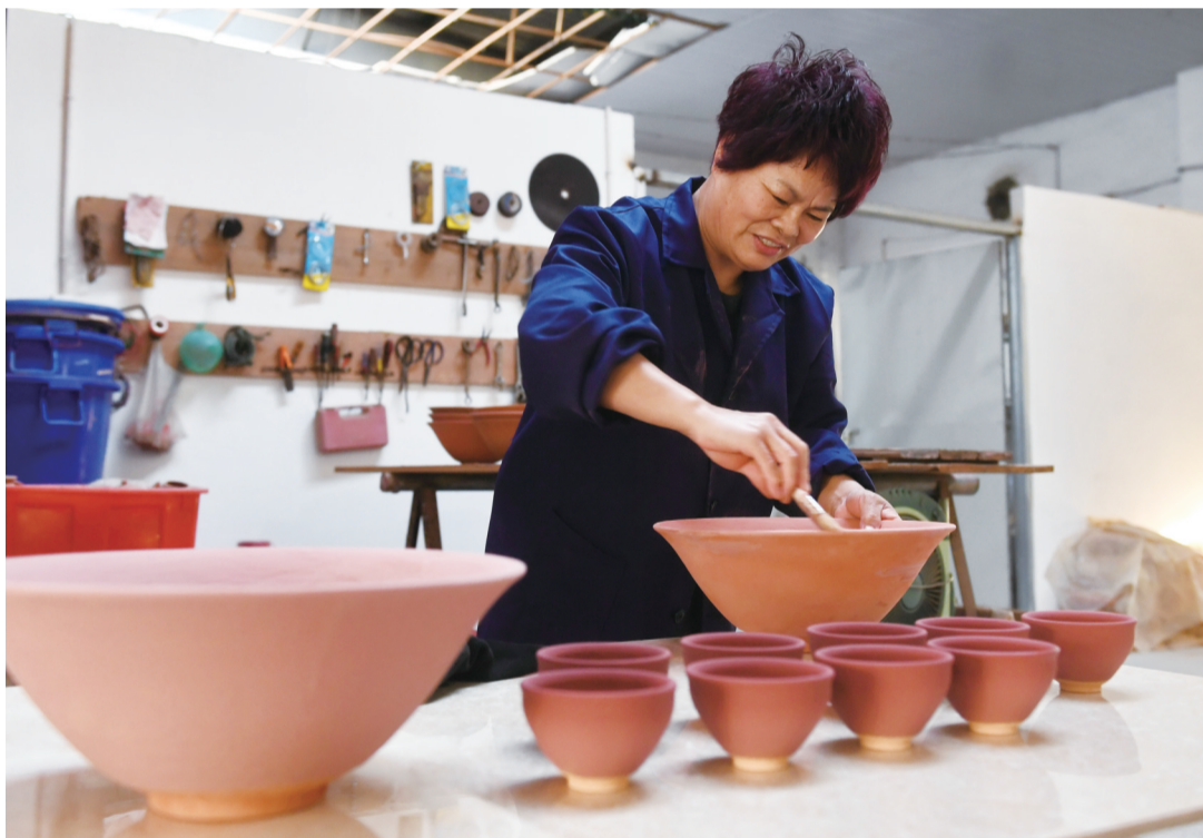
福建建阳的建窑曾是宋代八大名窑之一。建窑出产的黑釉瓷器——建盏一度经海上丝绸之路热销海外。宋代之后,建盏烧制技艺失传。近年来,在当地政府和陶艺工匠的共同努力下,国家级非物质文化遗产“建窑建盏烧制技艺”得以迅速恢复和发展。目前,南平市建阳建盏年产值达16.5亿元,产品远销日本、英国、美国等国家和地区。图为建阳建盏传统技艺传承人李细妹在给建盏坯体上釉。
