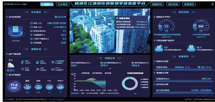
在节能改造过程中，江浦路街道办公楼整栋楼搭建了楼宇自控系统、环境监测系统和能源监测系统，实现能源管理的数字化，提高管理效率。改造之后，能源使用可达到国家近零能耗建筑的要求，年综合节能率可达60%以上。
